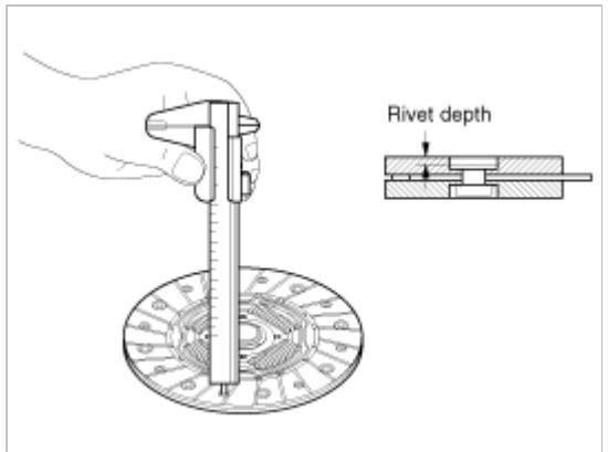
3. 检查扭转弹簧的间隙及损坏情况,如有缺陷,更换离合器片。
