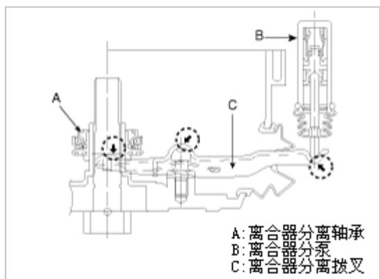
1. 检查轴承有无咬粘、损坏或异响并检查膜片弹簧接触面有无磨损。
